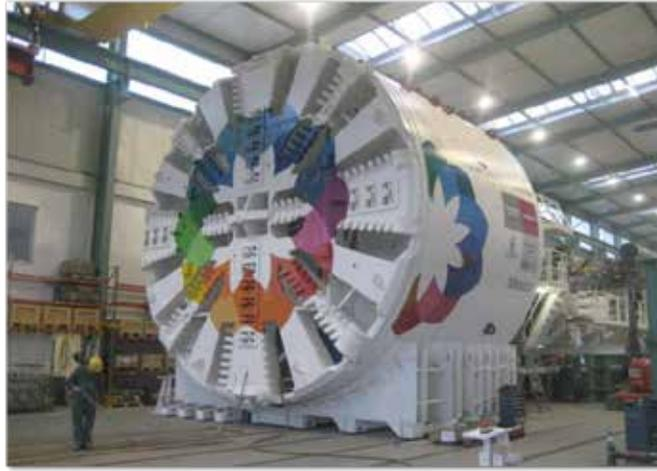
Figura 1. Montaje preliminar de la tuneladora TBM
