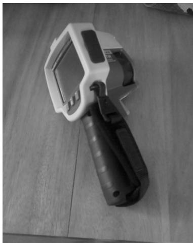
*Figura 6. Cámara Fototérmica Marca Fluke Modelo TiR.*
