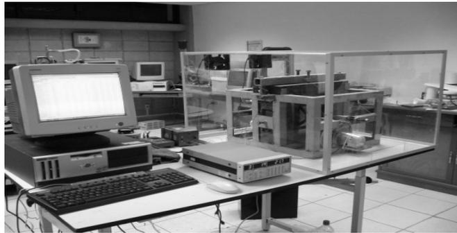
Figura 1. Conductímetro de Placa Caliente Guardada.
