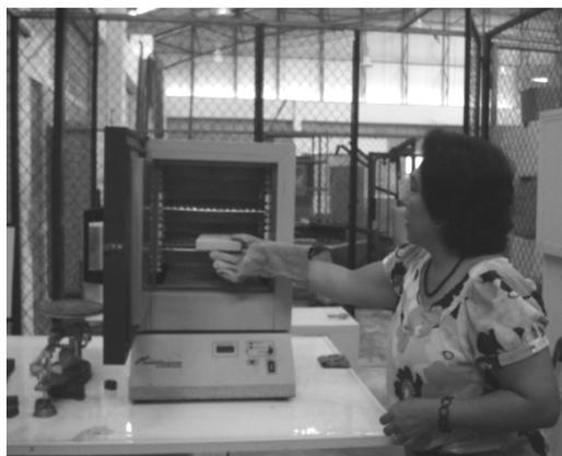
Figura 4. Colocación de muestras en el horno para cálculo de densidad.
