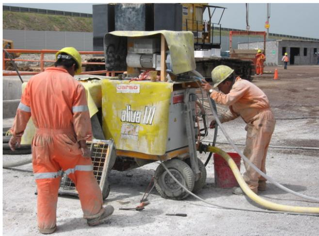
*Fig.5. Máquina utilizada para lanzar concreto (Aliva)*
