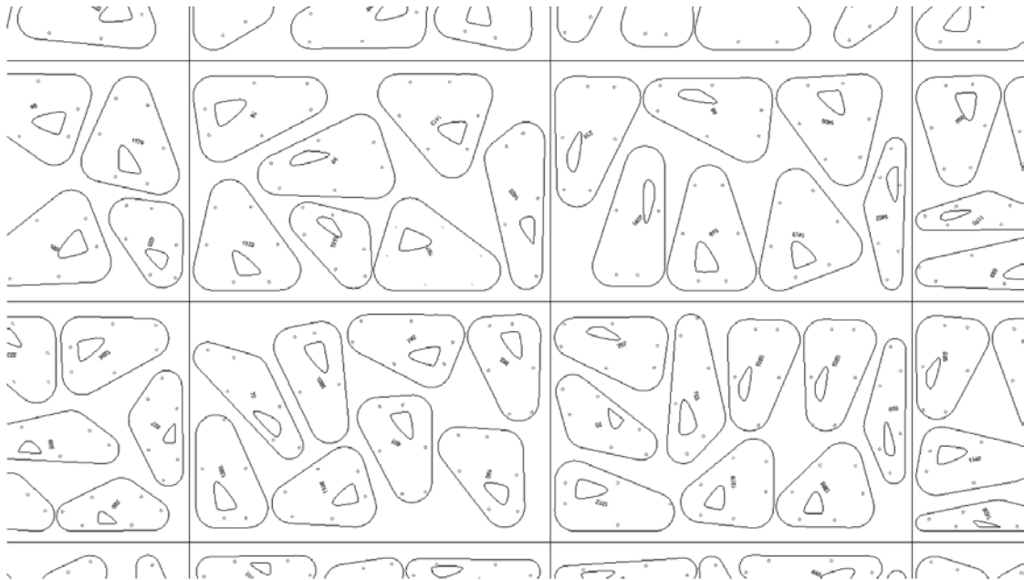
Figura 7. Packing: Empaquetado de geometrías dentro de área máxima de material. Composición de Piezas para corte laser. Arq. David Hernández. 2011.
