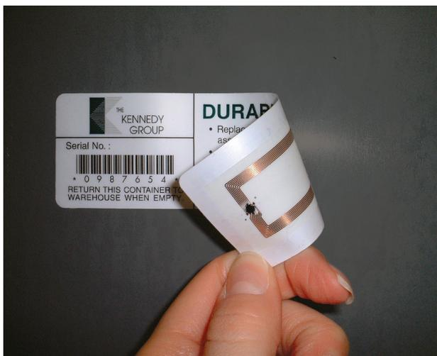
Imagen 5. Uso de la Radio Frecuencia en una etiqueta. En la etiqueta se encuentra integrado un micro circuito metálico que tiene como propósito transmitir datos utilizando el internet de las cosas.
