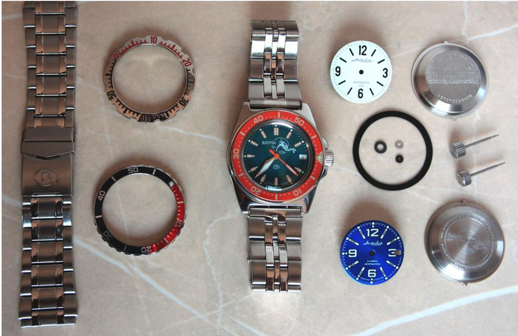
Imagen 14. Vostok Anfibia modelo 110, calibre 2416 (automático con fechador), con un conjunto de elementos utilizados para personalizarlo. Se aprecia brazalete, biseles, carátulas, tapas y coronas. Se muestra también el conjunto de empaques que utilizan estos relojes, tanto para la caja como para la corona. (Fotografía: Segurajáuregui/Cotto)
