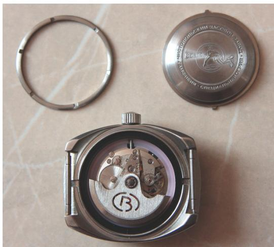
Imagen 13.67 Vostok Anfibia modelo 090, calibre 2415 (automático sin fechador). Se puede observar el empaque de goma sinterizado, utilizado en estos relojes para garantizar la hermeticidad de la caja, así como la tapa y el anillo roscado de bloqueo. (Fotografía: Segurajáuregui/Cotto)
