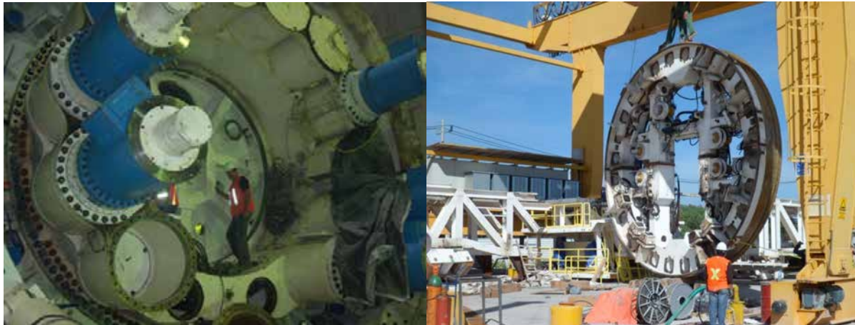
Figura 4. Vista de motores eléctricos ya instalados (izq.) y articulación (der.)
