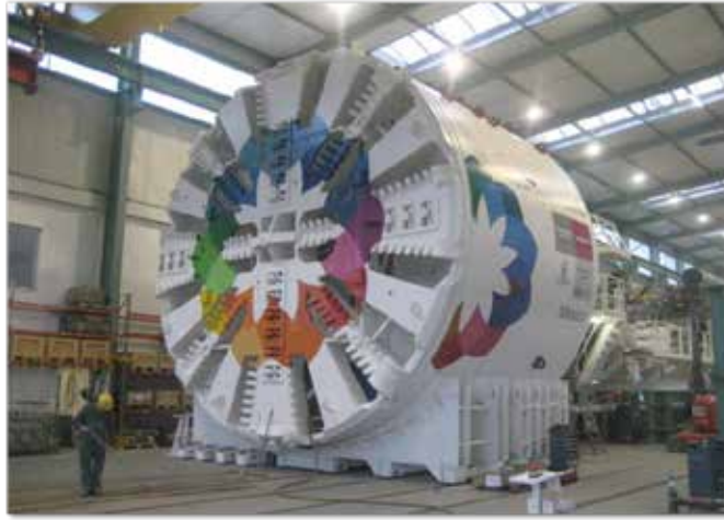
Figura 1. Montaje preliminar de la tuneladora TBM
