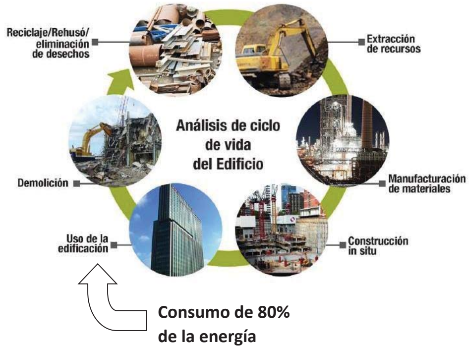
Figura 3: Fases del ciclo de vida del edificio
