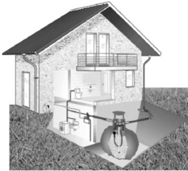
Captación y sistema de dotación de agua pluvial<sup>7</sup>
