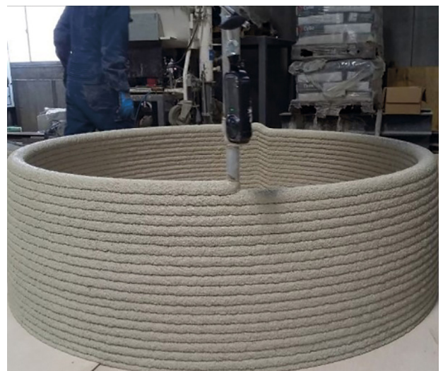
Figura 1. "Impresión" en 3D de tanques para conservar vino. Fuente: Global Construction Online (GCO)
