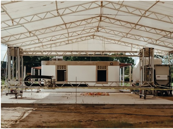
Figura 7. Impresora de casas Vulcan II, de la empresa ICON. Fuente: New Story, 2019.
