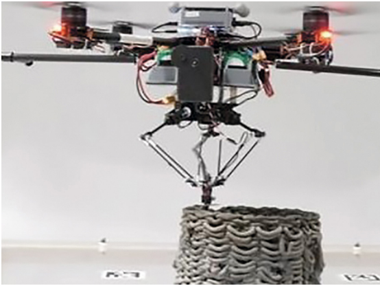
Figura 6. Prueba de impresión 3D utilizando drones. Fuente: Zhang, K. et al., 2022.
